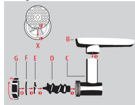
1 Schieben Sie die Schnecke D, mit der Kunststoffkupplung voran, bis zum Anschlag in das Gehäuse C.
