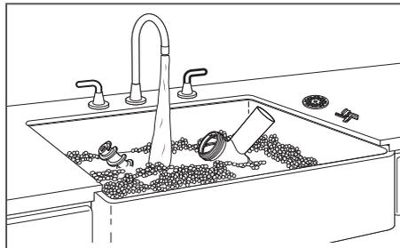
Die folgenden Teile sollten von Hand in warmem Seifenwasser gereinigt und gründlich getrocknet werden: Gehäuse, Mahlschnecke, Mahlscheiben und Messer.
