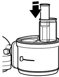
Zum Schneiden oder Reiben kleiner Zutaten setzen Sie den zweiteiligen Zutatenstopfer in den Einfüllstutzen ein; die kleinere Öffnung sollte wie abgebildet ausgerichtet sein.
