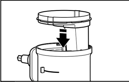
**1** Setzen Sie den Einsatz so in die Vorsatzeinheit, dass die Einfüllstutzen übereinander stehen und der Einsatz horizontal ausgerichtet ist.
