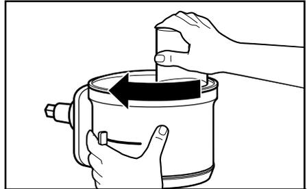
Halten Sie den Deckel am Einfüllstutzen und drehen Sie ihn im Uhrzeigersinn, um ihn vom Antriebsadapter des Food-Processor-Vorsatzes abzunehmen.
