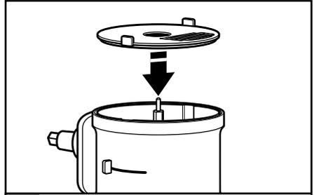
**2** Halten Sie die Würfelscheibe am Mittelloch und der Scheibenkante; die Lippe für den Schacht weist nach UNTEN. Setzen Sie die Scheibe so auf den Einsatz, dass das Würfelgitter über dem Einfüllstutzen des Einsatzes liegt.
