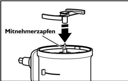
**3** Setzen Sie das Messer oben auf die Würfelscheibe, indem Sie es über den Mitnehmerzapfen schieben.
